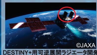
©JAXA DESTINY+用可逆展開ラジエータ開発
