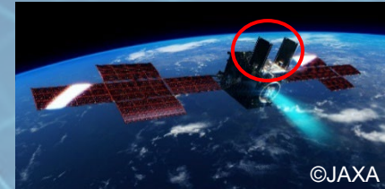
©JAXA DESTINY+用可逆展開ラジエータ開発
